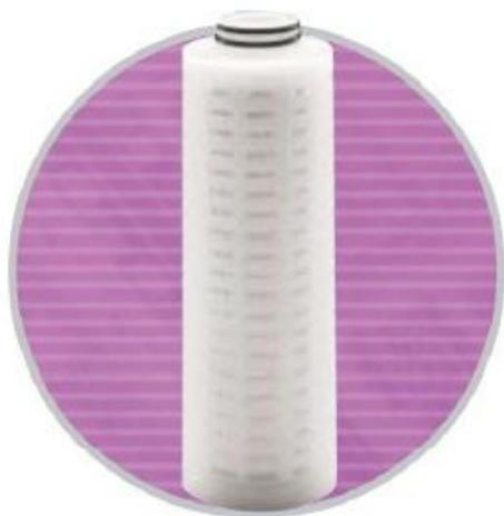
100%フロロポリマーで構成したメンブレンフィルターです。耐薬品、耐熱性に優れており、あらゆる流体条件下でご使用頂けます。特に半導体製造プロセスの高温の高純度化学薬品の精製、ELグレードの薬品のろ過に最適です。独自のブリーツ加工技術により、有効ろ過面積が大きく高流量、低圧損、ロングライフとなります。全品完全性試験を実施しておりますので安心してご使用頂けます。
