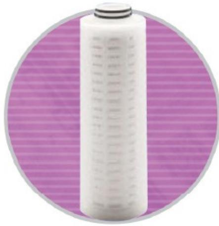
100%フロロポリマーで構成したメンブレンフィルターです。耐薬品、耐熱性で優れており、あらゆる流体条件下ご使用頂けます。特に半導体製造プロセスの高温の高純度化学薬品の精製、ELグレードの薬品のろ過に最適です。独自のプリーツ加工技術により、有効ろ過面積が大きく高流量、低圧損、ロングライフとなります。全品完全性試験を施しておりますので安心してご使用頂けます。
