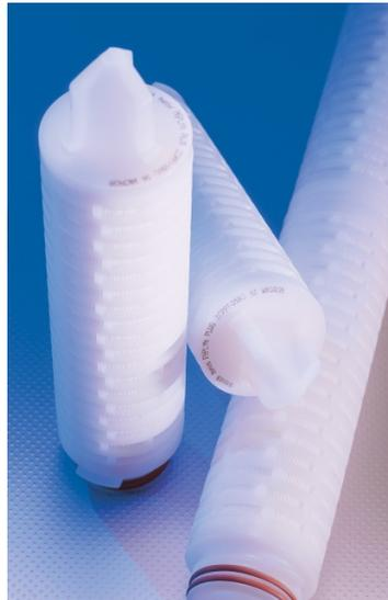
耐薬品に優れた PTFE メンブレンを搭載したフィルターです。化学薬品用途は勿論の事、膜が疎水性の為、除菌用タンクベントフィルターとしても最適です。濾過面積が大きく高流量、低圧損、ロングライフとなります。構成部材は、高温下の安定性にも優れ、スチーム滅菌処理にも対応しておりますので、食品、医薬のアプリケーションにも安心してご使用頂けます。親水性 PTFE タイプもご用意致しました。
