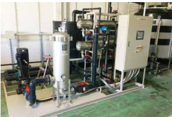
油分と水分を分離できる油水分離装置
